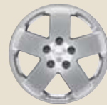
Sahara: cerchi in lega 18 x 7,5 Dimensione pneumatici 255/70 R18
